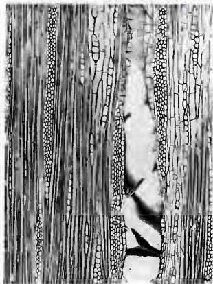
Pl. 2. — Bois de Vochysia neyratii : à gauche, section transversale \times 25 ; à droite, section longitudinale (angéielle) \times 55 .
